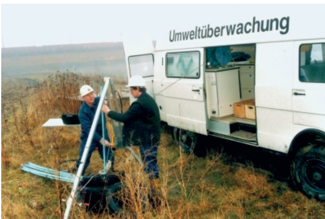
Sanierungsbegleitendes Monitoring: Mobiler Messtrupp bei der Überwachung der Grundwasserbeschaffenheit
