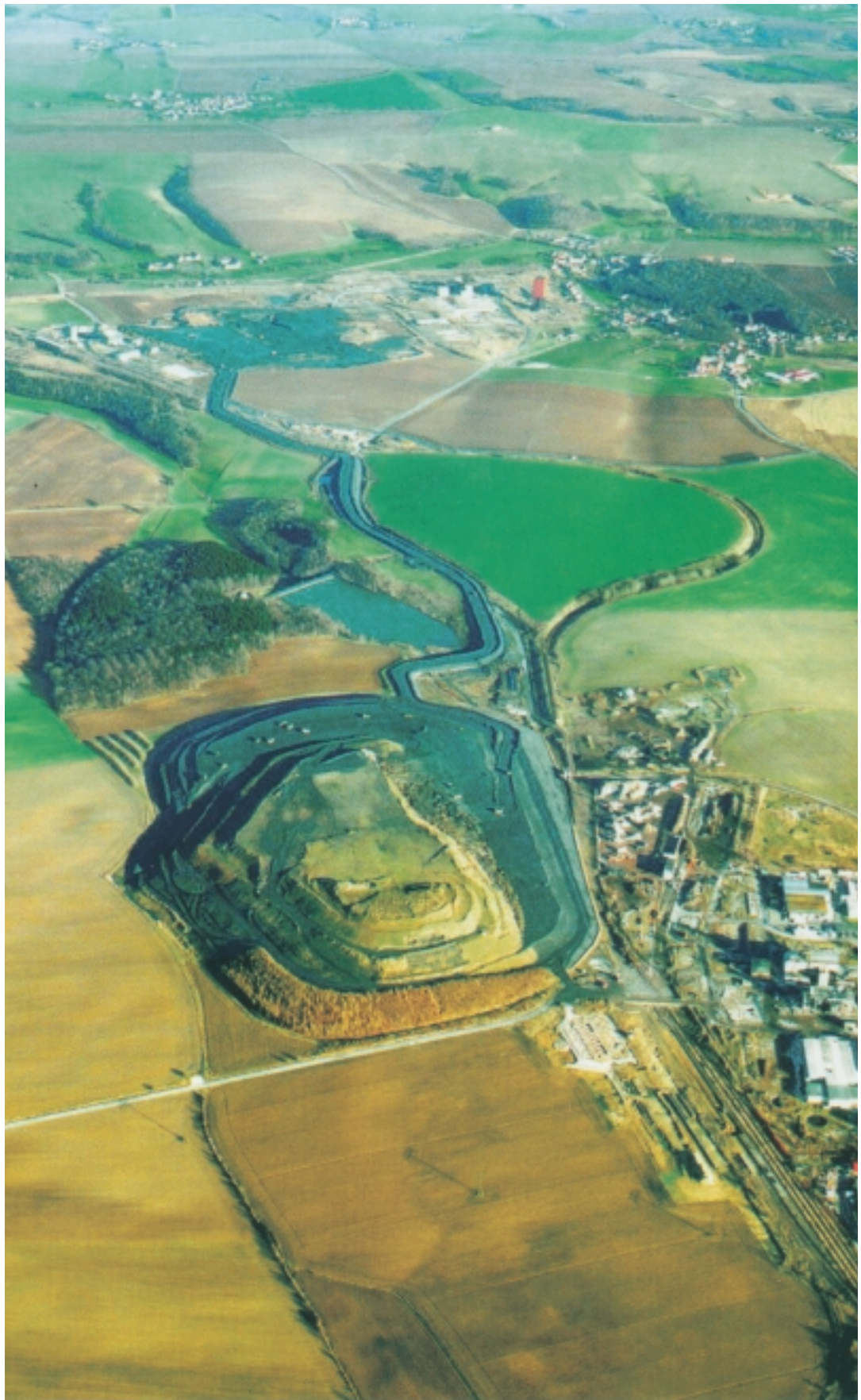
Halde Beerwalde mit Transporttrasse. Im Hintergrund die Aufstandsfläche der bereits umgelagerten Halde Drosen, Sanierungsbetrieb Ronneburg
